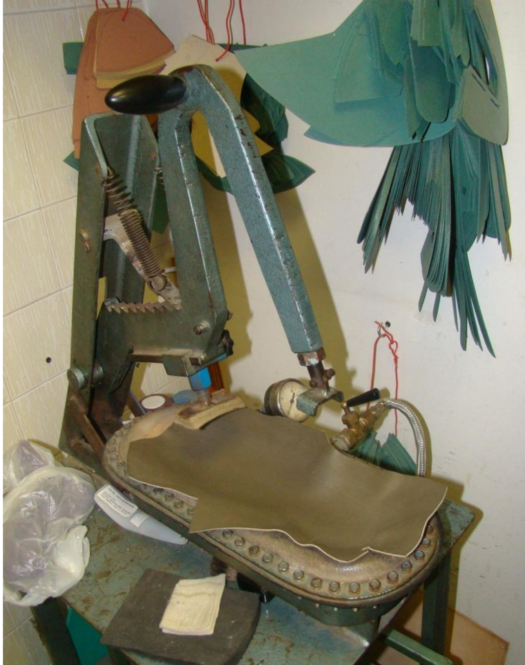
Uz vlastite ruke i šivaću mašinu, presa je svakom postolaru najvažniji stroj u radionici.
