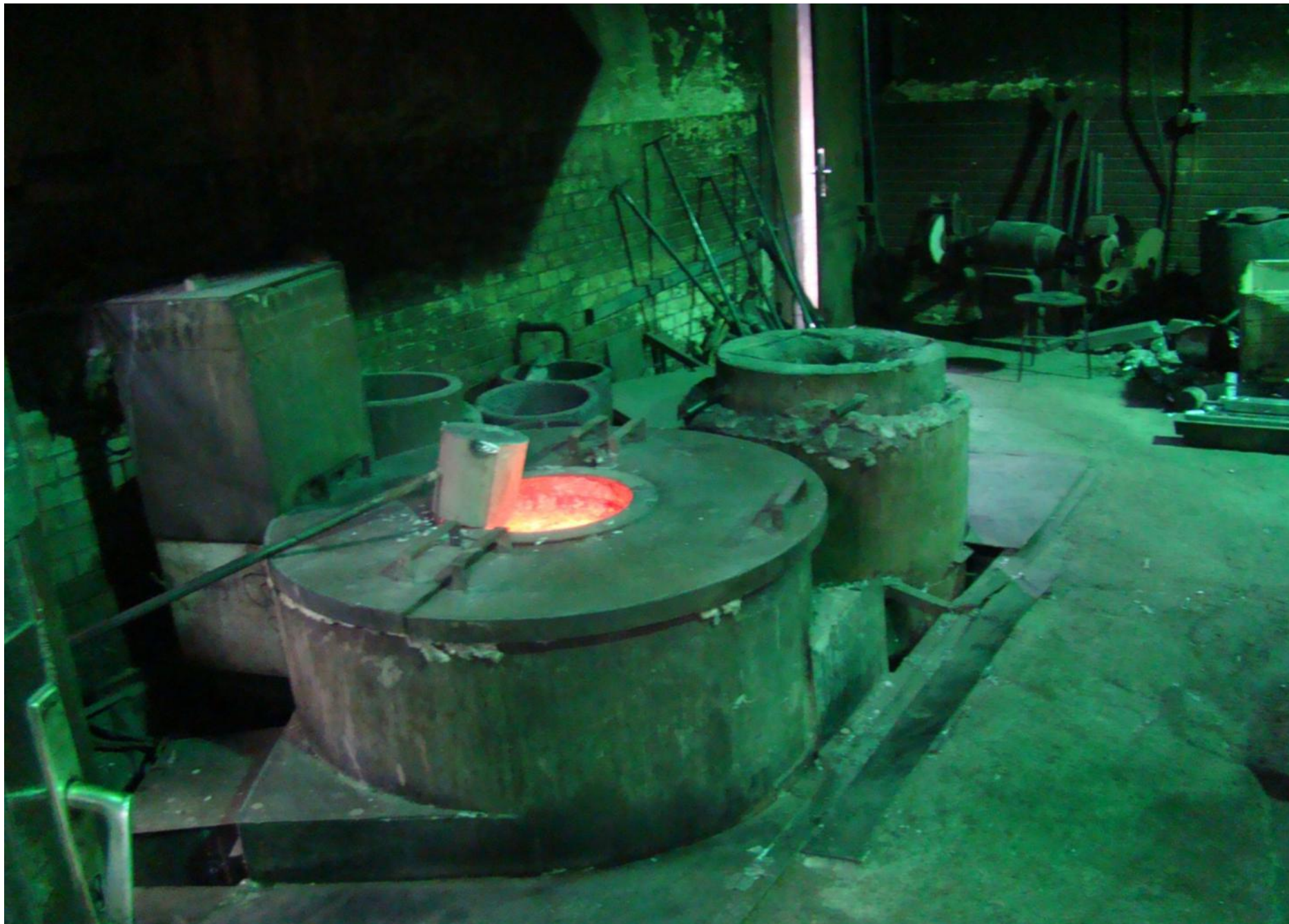
Željezna sirovina koja se koristi za izradu zvona, tali se na vrlo visokoj temperaturi.
