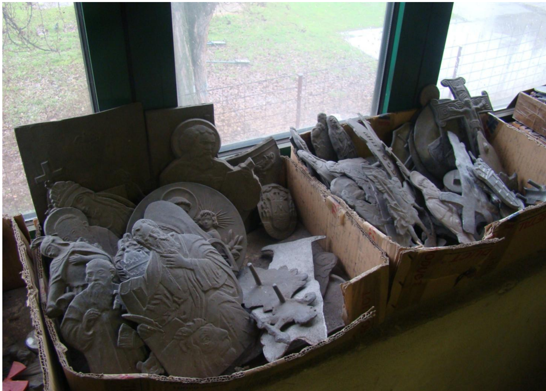
Na slici: kalupi za razne aplikacije koje se nalaze na zvonima.
