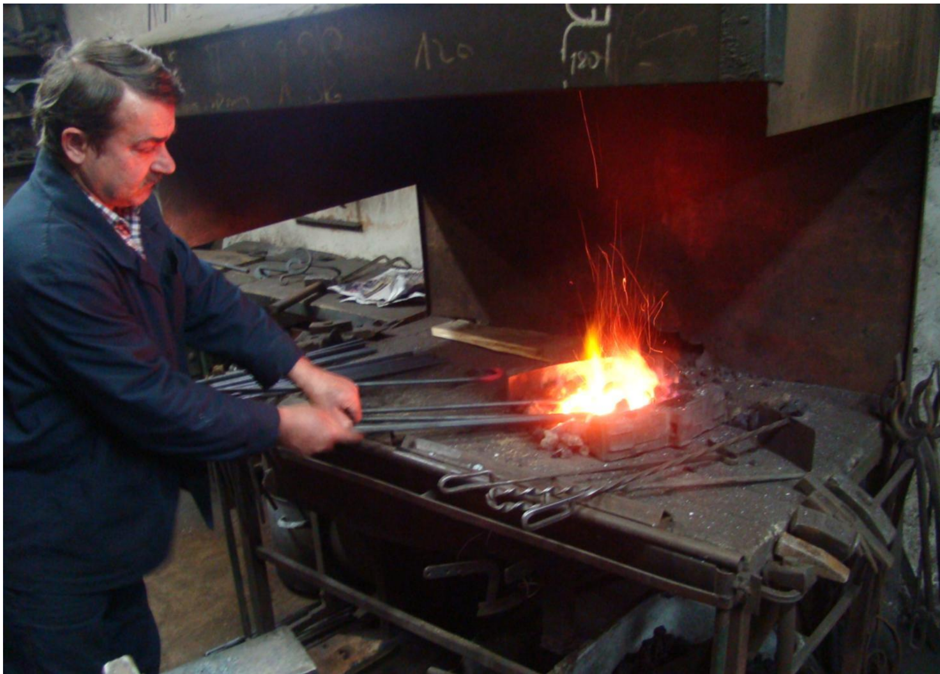
Većina dijelova za proizvode obrta Mastnak kuje se ručno.
