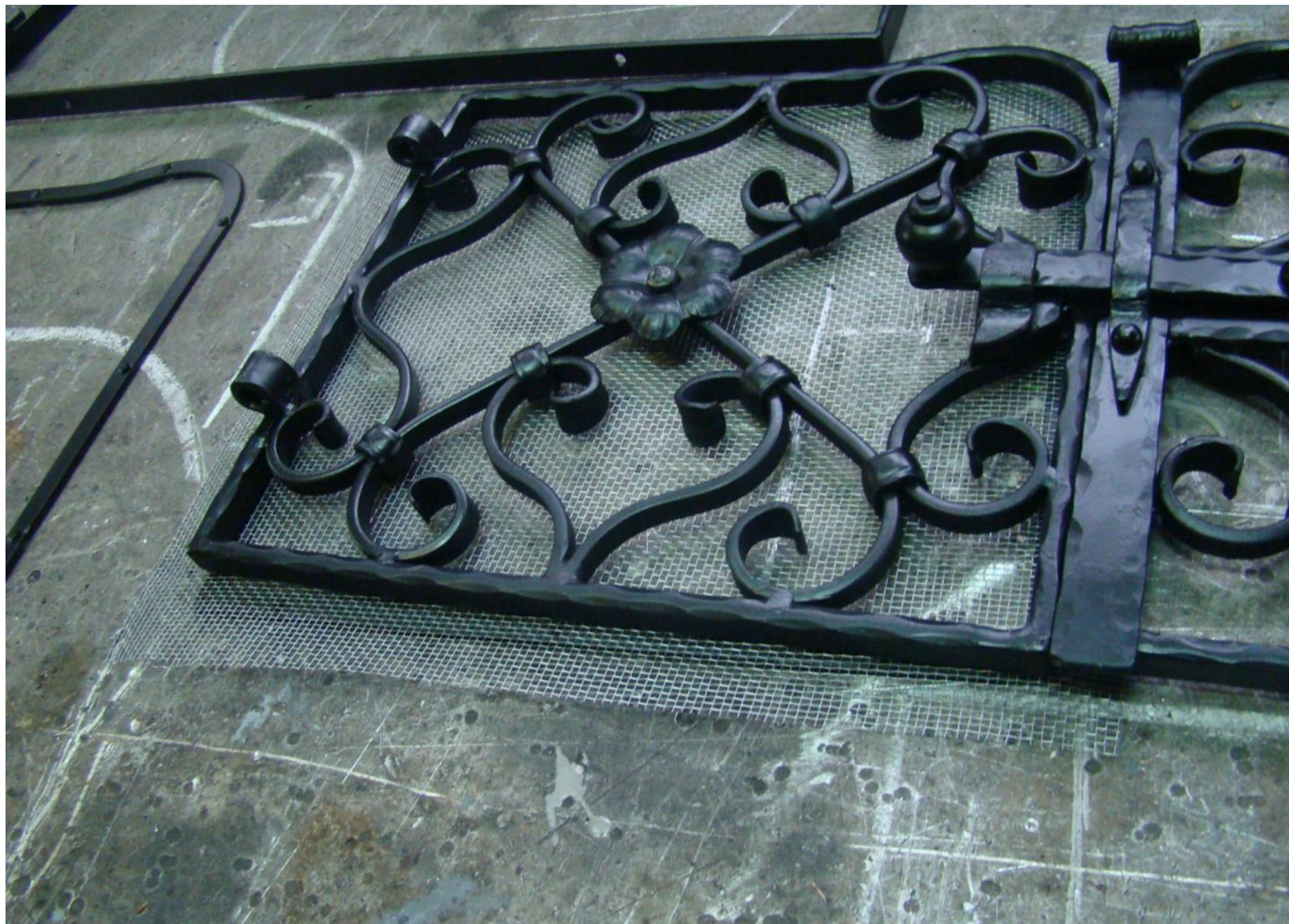
Na slici – detalj s ogradnih vrata – svaki dio ukras izrađen je ručno
